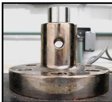
**Figuras 9 e 10** – Adaptador e base de aço inoxidável 316 L.
