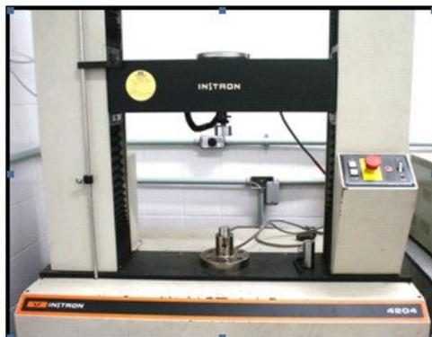
**Figura 8** – Máquina de teste mecânico utilizada nas análises de compressão axial, modelo Instron modelo 4204.
