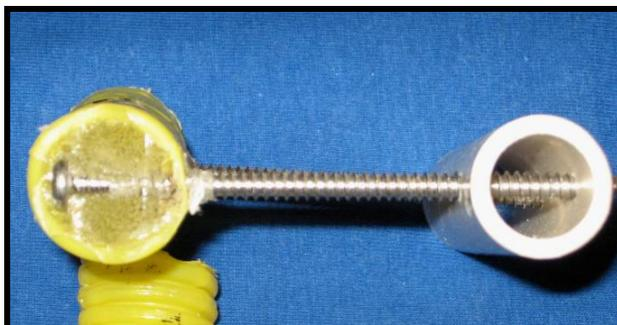
**Figura 23** – ponto de fratura na barra estabilizadora de resina, evidenciando a presença de micro bolhas.
