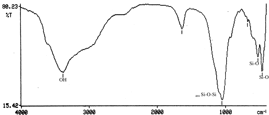
Figura 4.7: Espectro no infravermelho da montmorilonita
