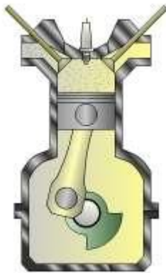
Figura 4. Posição das válvulas durante o segundo curso do pistão na fase de compressão.
