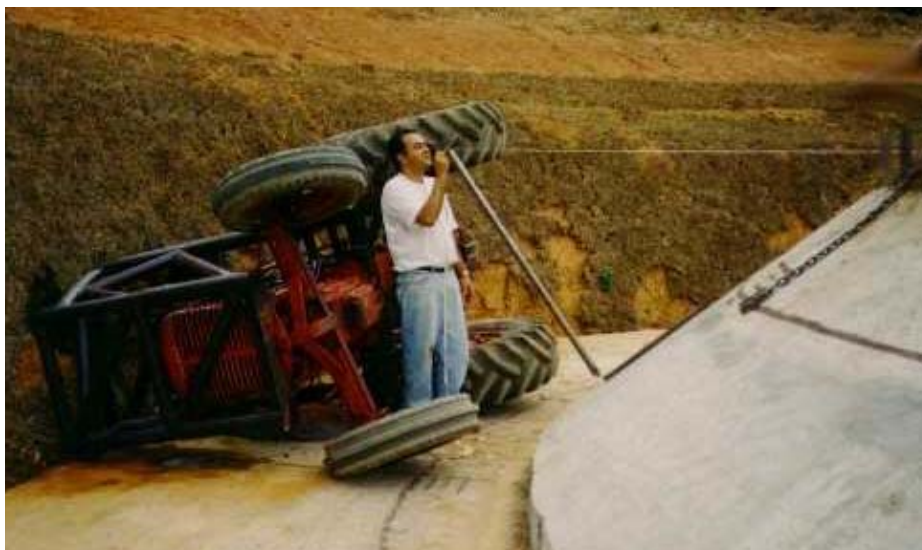
(2) medição do raio de curva no local do tombamento.
