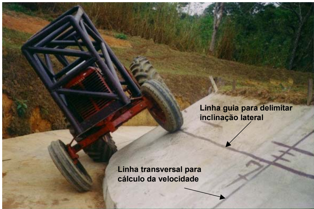
Figura 5 - Trator observado de frente, fazendo operação de curva em pista inclinada, em curva de nível, a uma velocidade constante, ângulo \varphi = 90^\circ .
