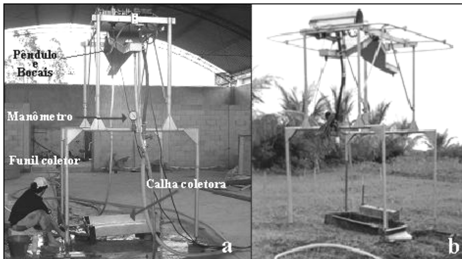
Figura 2. Instalação do simulador de chuva em laboratório (a) e no campo (b).
