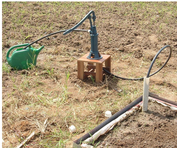
Figura 19 – Bomba de pistão utilizada na drenagem da caixa.
