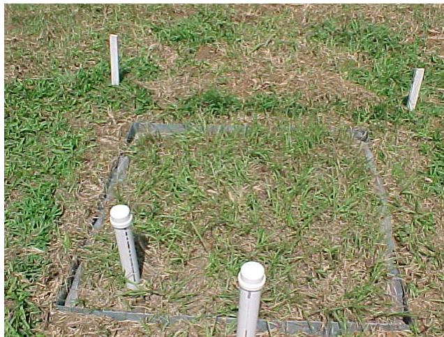
Figura 15 – Lisímetro com plantio de grama.
