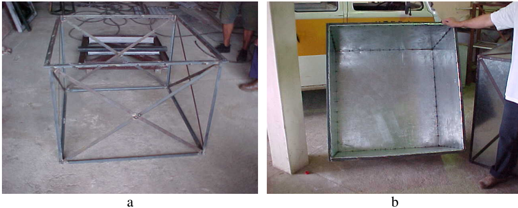
Figura 7 – Armação da caixa lisimétrica (a) e vista parcial da caixa após fixação das chapas (b).
