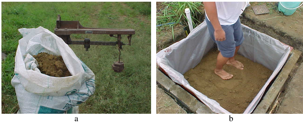
Figura 13 – Pesagem do solo (a) e preenchimento do lisímetro (b).
