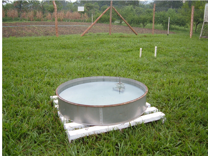
Figura 18 – Tanque Classe A instalado ao lado do lisímetro.
