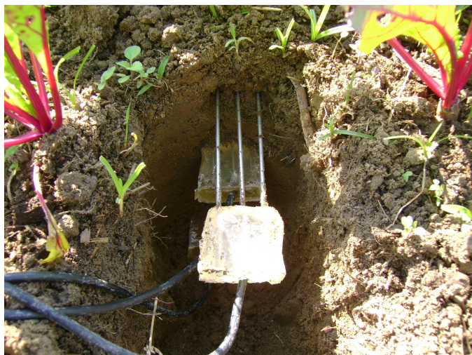
Figura 6. Cultivo orgânico da beterraba ( Beta vulgaris ‘Early Wonder Tall Top’): posicionamento dos sensores (TDR) no centro do canteiro, a profundidade de 0,10; 0,20 e 0,30 m para manejo da irrigação (Seropédica – RJ, 2008).
