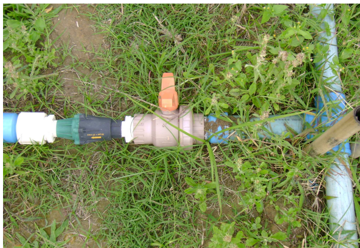
Figura 3. Cultivo orgânico da beterraba ( Beta vulgaris ‘Early Wonder Tall Top’): conjunto registro de esfera e válvula reguladora de pressão (210 kPa) para controle de vazão e pressão na linha de derivação (Seropédica – RJ, 2008).
